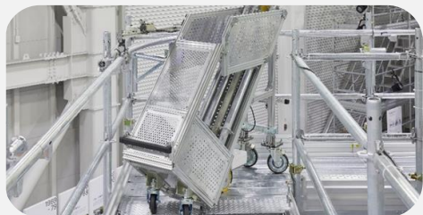
T-Rook 仮設構造物内で仮設機材の運搬を行うロボット
