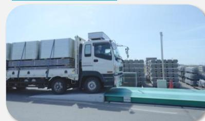
仮設機材を入庫する際に、必要な数と種類を正確に識別するため、トラックスケールによる重量データの蓄積と、定点カメラによる識別を行い、仮設機材提供および返却の正確性を格段に向上。工事現場で数が足りない、提供した分が返却されていないなどのヒューマンエラーを撲滅
