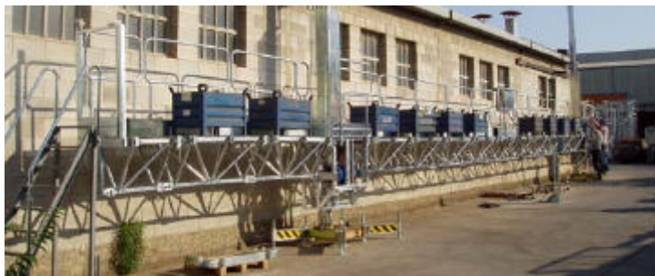
小型リフトクライマー（試験運転の様子）
