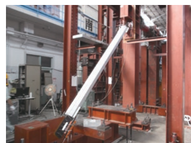
座屈拘束(制振)ブレース「オクトブレース」
