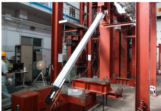
オクトブレースの性能試験
